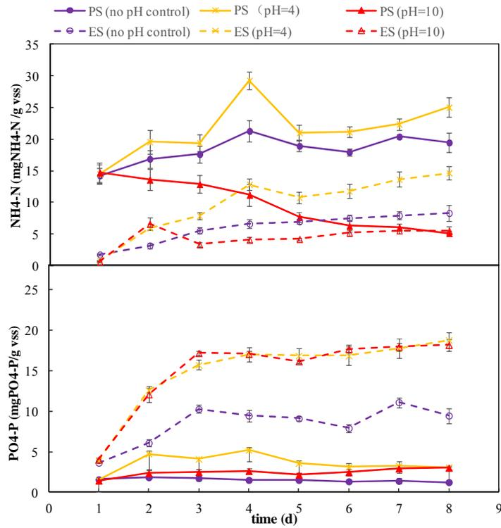
Figure 2  $\text{NH}_4^+\text{-N}$  and  $\text{PO}_4^{3-}\text{-P}$  release in fermentation
